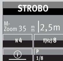
Im Display wird die zu den eingestellten Parametern gültige Entfernung angezeigt.
