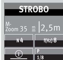
Sul display viene indicata la distanza valida per i parametri impostati.
