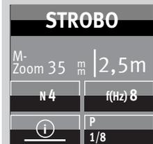
En la pantalla se muestra la distancia válida para los parámetros configurados.
